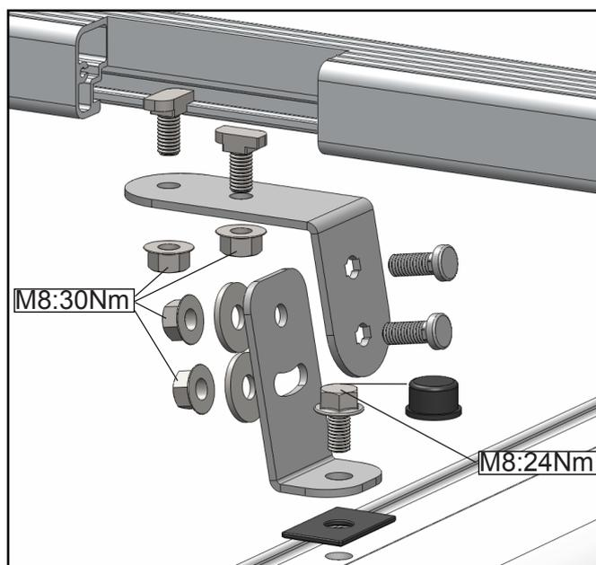
**Каждый раз проверяйте, чтобы болты и гайки были закручены.**
